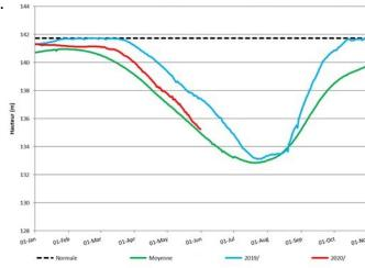
Niveau du plan d'eau au barrage de Kanji/Reservoir Water Level at Kanji Da
